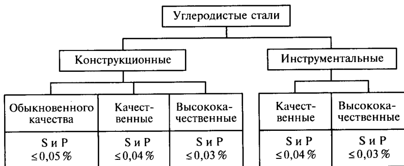
Рис. 3.20. Классификация углеродистых сталей по назначению и качеству (указаны допустимые содержания каждой из примесей — S и P)
