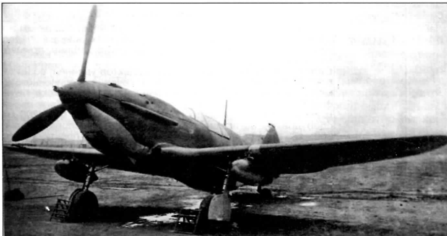
Построенный в Таганроге ЛаГГ-3 (зав. № 213191) с подвесными 100-л топливными баками, предназначенный для авиации флота. Сентябрь 1941 г. ЛаГГ-3 (s/n 213191) built in Taganrog with 100 l external tanks, intended for Navy aviation. September 1941
