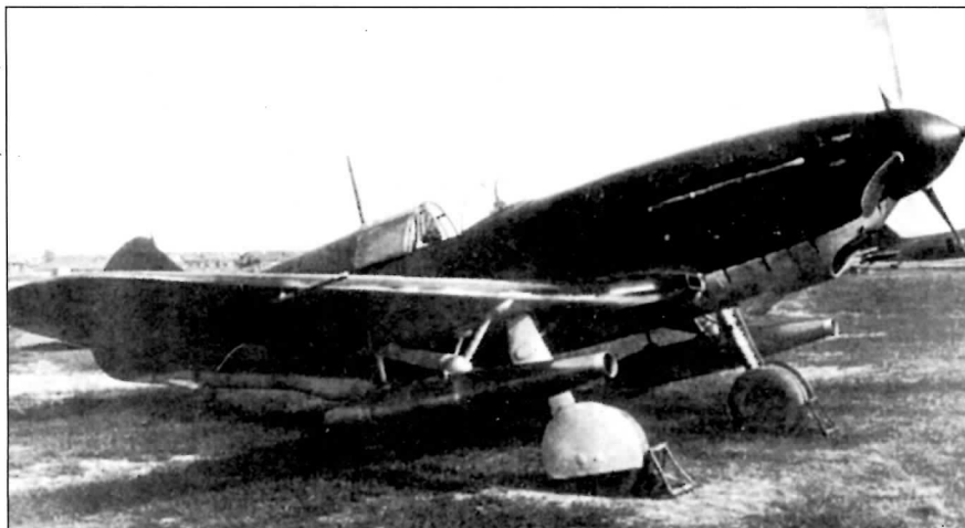
Опытный ЛаГГ-3 с дополнительными пульсирующими воздушно-реактивными двигателями ВРД-1 Experimental LaGG-3 with additional pulsejet engine ВРД-1
