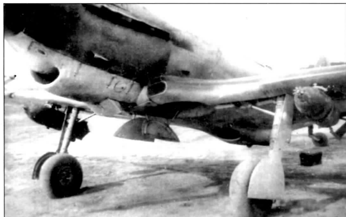
ЛаГГ-3 66-й серии: основные опоры шасси и подвешенные бомбы ФАБ-50
