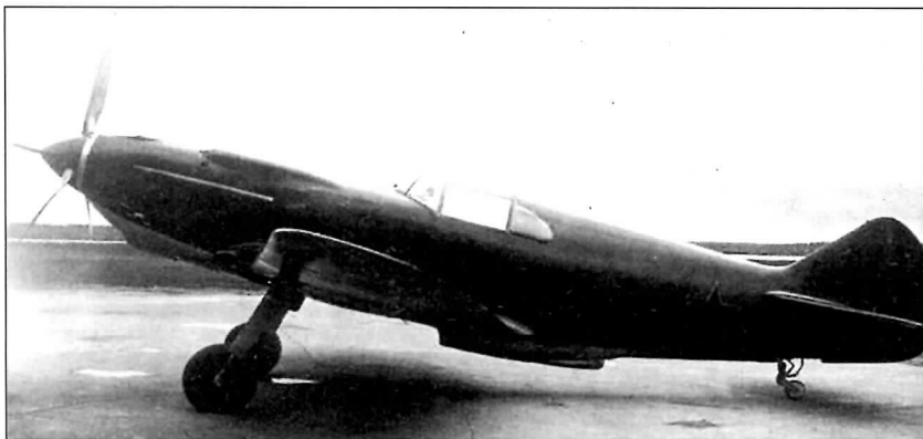
Истребитель танков К-37 (Гу-37) с 37-мм пушкой Ш-37. Справа — отсек вооружения ЛаГГ-3 34-й серии. Виден пулемет УБС, его патронный ящик, а также 37-мм снаряды
