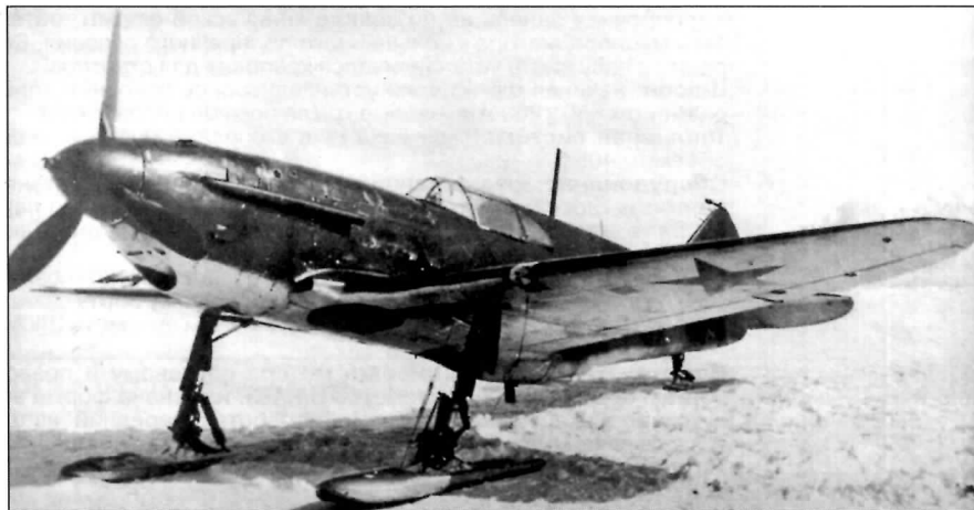
ЛаГГ-3 8-й серии на лыжном шасси ЛаГГ-3 of 8th series on ski landing gear
