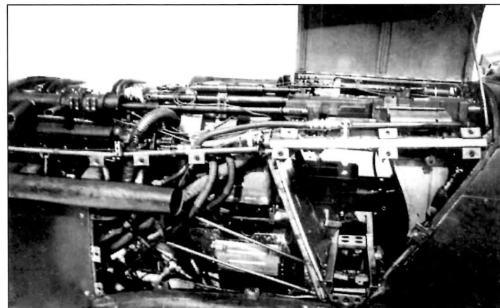
Отсек вооружения ЛаГГ-3 4-й серии LaGG-3 of 1st series weapons compartment
