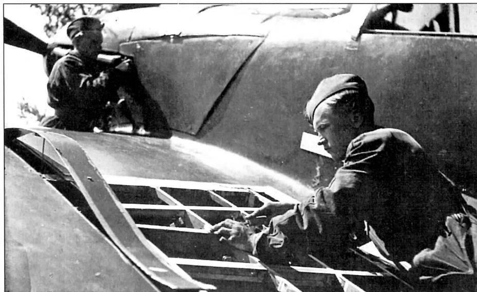
Ремонтировать цельнодеревянную конструкцию ЛаГГ-3 в полевых условиях было не так уж и просто
