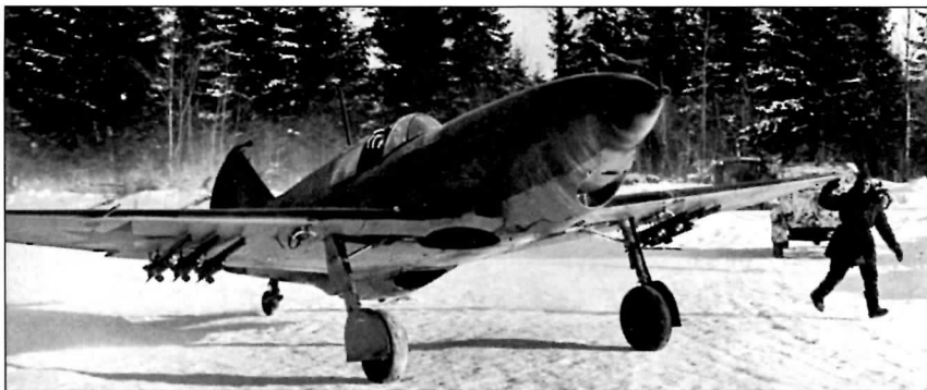
Вооруженный РСами ЛаГГ-3 8-й серии отправляется на штурмовку Equipped by RSes unguided missiles LaGG-3 of 8th series taking off for assault mission
