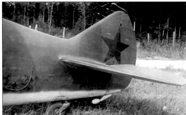
Хвостовое оперение раннего ЛаГГ-3 с двумя балансирами на руле направления
