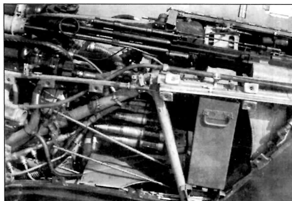
Истребитель танков К-37 (Гу-37) с 37-мм пушкой Ш-37. Справа — отсек вооружения ЛаГГ-3 34-й серии. Виден пулемет УБС, его патронный ящик, а также 37-мм снаряды
