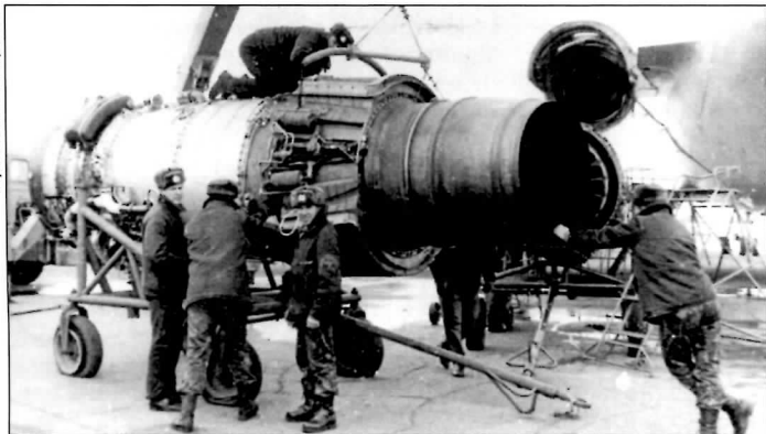
Замена двигателя на Ту-154 из состава 978-го ОТАП
