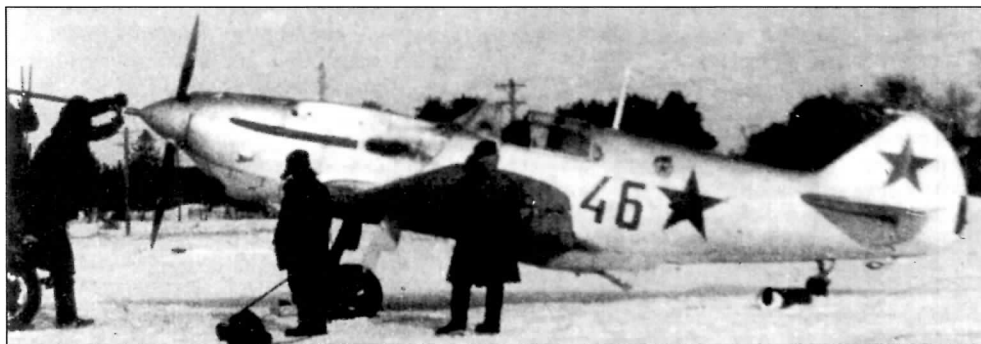
Запуск от автостартера двигателя истребителя из 3-го ГвИАП ВВС Балтфлота. Зима 1942 г.
