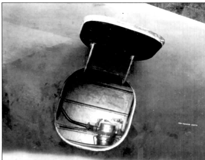
Открытый люк на левом борту фюзеляжа Open radio door on the left side of the fuselage
